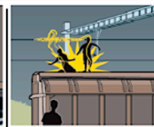
L'arc électrique s'est formé lorsque les deux victimes étaient sur le toit du wagon. Le courant est sorti du câble et a traversé leur corps.
